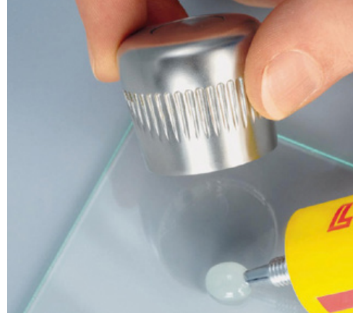
Durch Kleben lassen sich auch artverschiedene Werkstoffe wie nichtrostender Stahl und Glas miteinander verbinden. Foto: Henkel Loctite, Düsseldorf (D)
